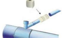
Rohr mit Isolierbinde abdichten
