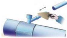
Reinigen des Rohres mittels Spachtel.
