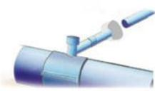
Rohrende mit Stoffzetteln verschließen
