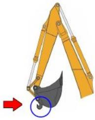
Les engins de génie civil utilisés comme appareil de levage doivent donc être couverts par une autorisation d'exploitation conformément à la loi modifiée du 10 juin 1999 relative aux établissements classés. **Dans tous les cas des contrôles périodiques par un organisme de contrôle agréé sont demandés et à effectuer.**
