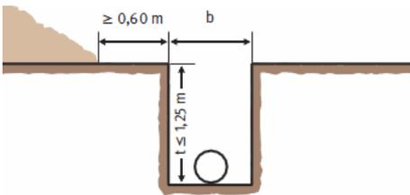
Des tranchées peuvent être creusées avec des parois verticales sans blindage jusqu'à une profondeur de 1,25 m.
