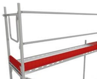
Les planchers de travail sont à protéger avec des garde-corps complets composés d'une lisse supérieure située à 1 m, d'une lisse intermédiaire située à 0,50 m et d'une plinthe d'une hauteur d'au moins 10 cm. D'autres solutions sont des écrans (treillis ou planchers supplémentaires) et filets ou surfaces de recueil.
