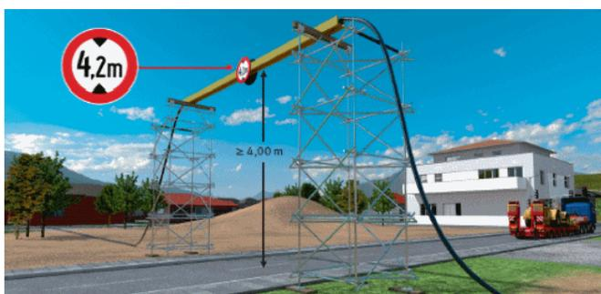
Observer un espace libre suffisant entre les voies de circulation pour véhicules et les conduites aériennes d'approvisionnement ou fixe et prévoir des panneaux de signalisation "Accès interdit aux véhicules ayant une hauteur supérieure à 4,5 mètres"
