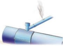
Beschädigte oder abgerissene Anschlussleitung Raccordement endommagé ou arraché.
