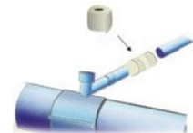
Rohr mit Isolierbinde abdichten Etanchéifier le tuyau à l'aide d'une bande d'isolation.
