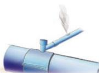
1. Raccordement endommagé ou arraché.
