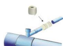
6. Etanchéifier le tuyau à l'aide d'une bande
